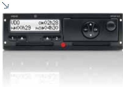
Sicherheitschip von Infineon im digitalen Fahrtenschreiber von Continental
