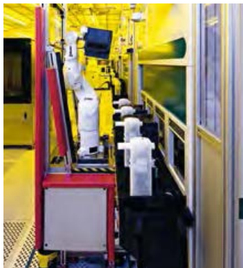
Im 200-Millimeter-Frontend-Standort Dresden: Fertigungslinie für Bauelemente mit kupferbasierten Verdrahtungsebenen
