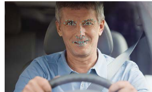
Die Position der 49 Bezugspunkte wurde mit der Bilderkennungsoftware von Kostal ermittelt.
