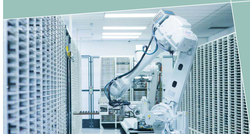
Einsatz von Robotern beim Ein- und Auslagern der schweren und fragilen Burn-in-Boards.
